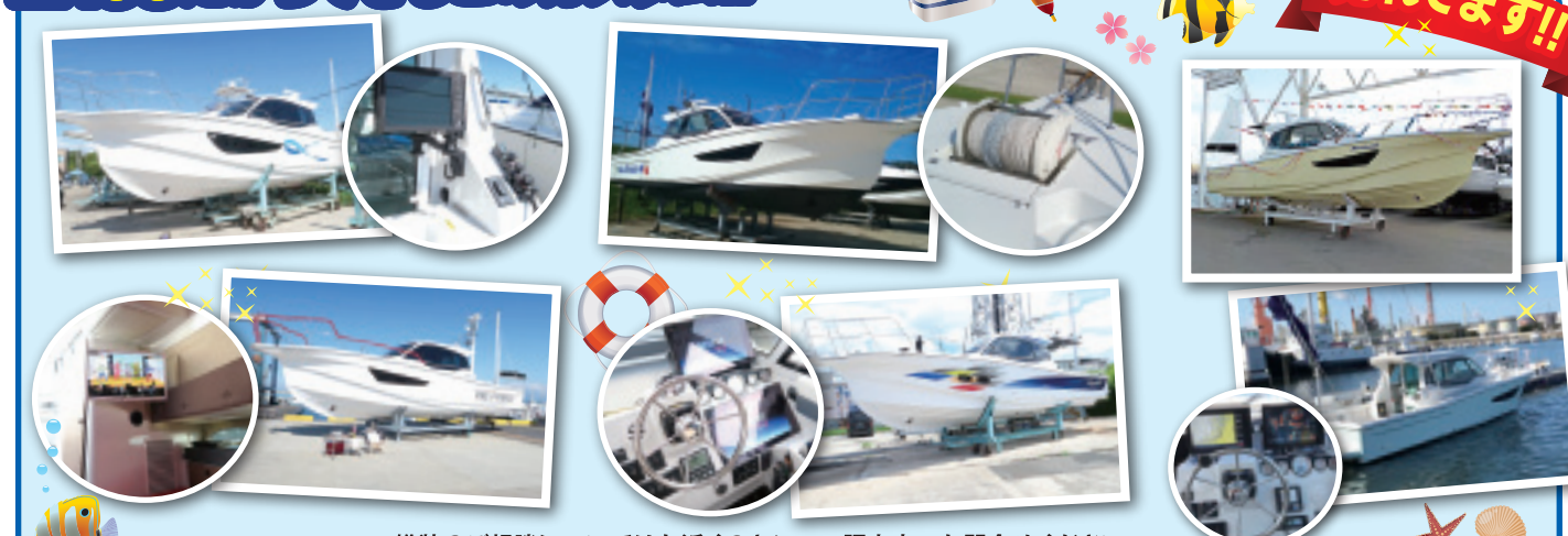
全長×全幅×全深: 12.39×3.40×1.93(m) 定員: 12名 搭載ENG: 6CXBS-GT(495PS) 総トン数: 5.0G/T未満 航行区域: 限定沿海/沿海
