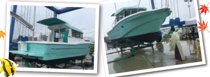
全長×全幅×全深：9.57×3.20×1.82(m) 定員：10名 搭載ENG：8LV350J(350PS) 総トン数：5.0G/T未満 航行区域：限定沿海/沿海
