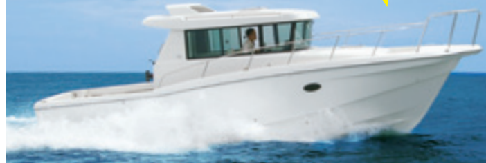
全長×全幅×全深: 9.57×3.20×1.82(m) 定員: 10名 搭載ENG: 8LV350(350ps)※FW出力値 総トン数: 5.0G/T超 航行区域: 限定沿海(沿岸対応可)
