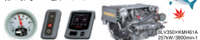
全長×全幅×全深: 9.57×3.20×1.82(m) 定員: 10名 搭載ENG: 8LV350(350ps)※FW出力値 総トン数: 5.0G/T超 航行区域: 限定沿海(沿岸対応可)
