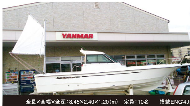
全長×全幅×全深: 8.45×2.40×1.20(m) 定員: 10名 搭載ENG: 4JH3-DTZA(115ps) 総トン数: 5.0G/T未満 航行区域: 限定沿海
